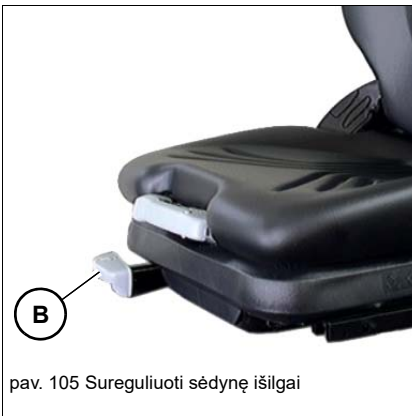
pav. 104 Sureguliuoti sėdynę išilgai
